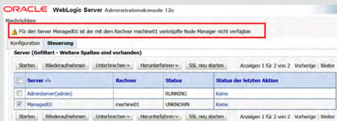
Abb. 4: Auszug der Admin-Konsole beim vergeblichen Versuch, einen Managed-Server zu starten. Das kann nicht funktionieren, denn der zugehörige Node Manager ist nicht verfügbar
